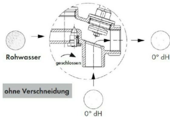
Bei zu geringer Wasserhärte wird die Regulierungsschraube links herum, bei zu hoher Wasserhärte Rechts herum gedreht.
