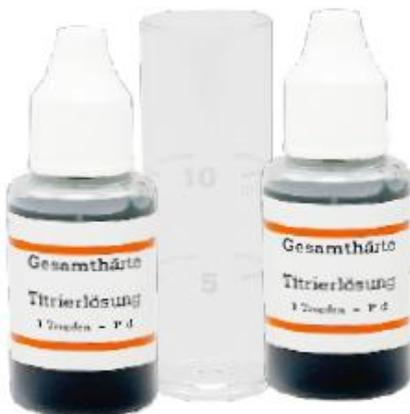
**Beispiel:** Sie befüllen die Pilone mit **5 ml** Wasser. Durch das Zutropfen der **grün** gefärbten Lösung wird der Härtegrad ermittelt. Bei **20 Tropfen** schlägt die Farbe von **rot** auf **grün** um. (Sie haben 20° deutsche Härte)
